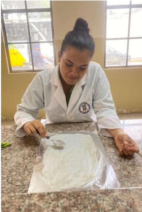
Figura 11. Moldeado de bioplástico. Sanchez, 2024
