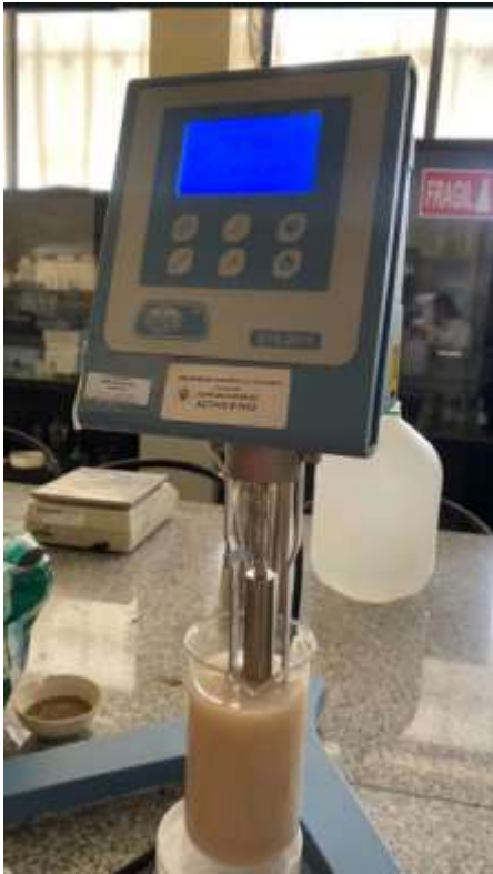
Figura 15. Análisis de viscosidad del almidón a partir de la semilla de mango.
