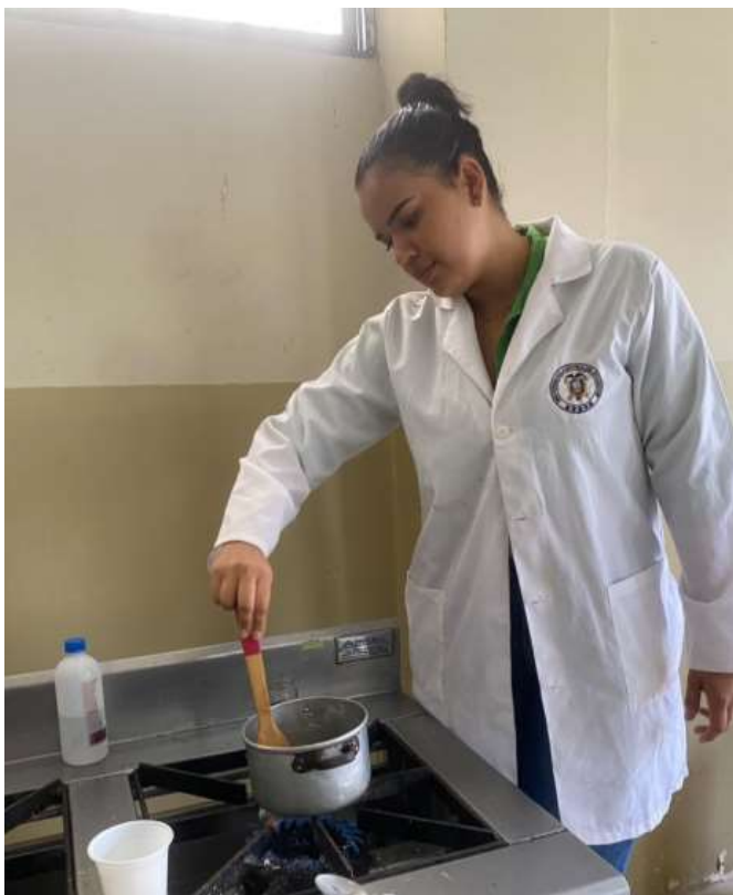
Figura 10. Elaboración del bioplástico a partir del almidón de la semilla de mango. Sanchez, 2024.
